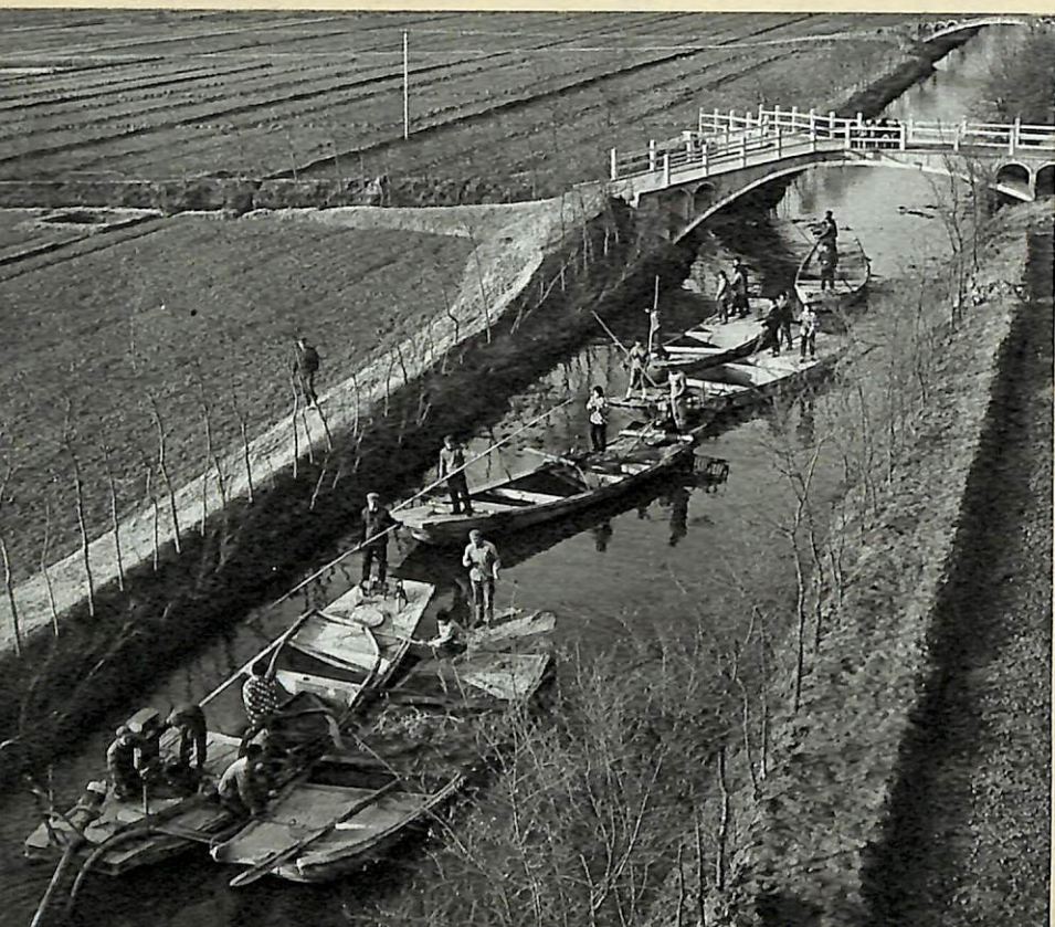
公社农机厂生产的吸泥船，成本低、效率高，减轻了社员的劳动强度。
