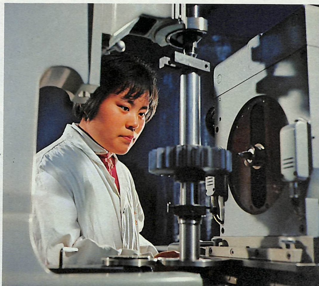
秦川机床厂生产的精密机床。这是工人正在测量新生产的机床齿轮的精度。
