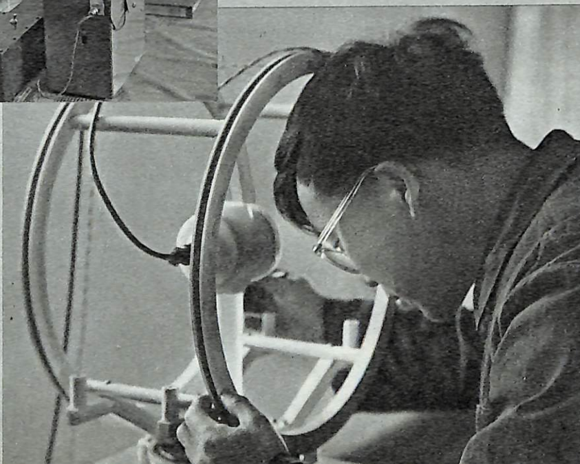
北京地磁台使用的国产核子旋进式磁力仪(上图)；地磁台工作人员在调整这种仪器的探头(下图)。
