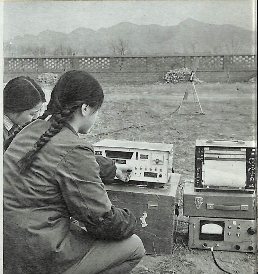
北京地质仪器厂和科研单位共同试制成功的供航空地球物理勘探用的光泵磁力仪。这是工厂将这种仪器拿到北京郊区作试验。
