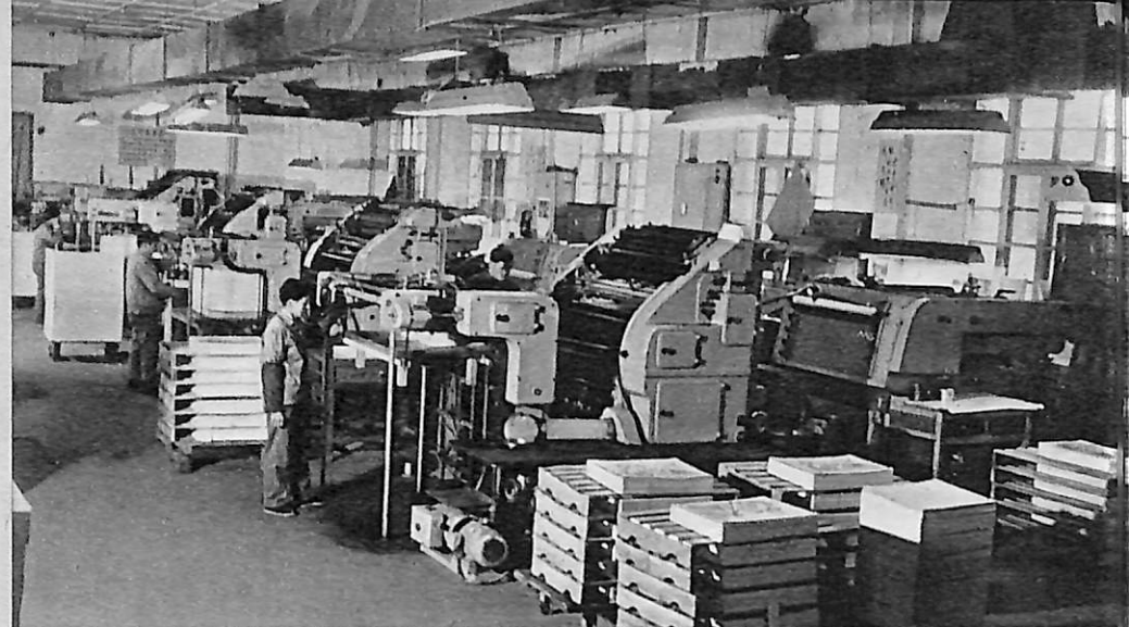
江苏新华印刷厂胶印车间工人在用国产双色胶印机印刷。
