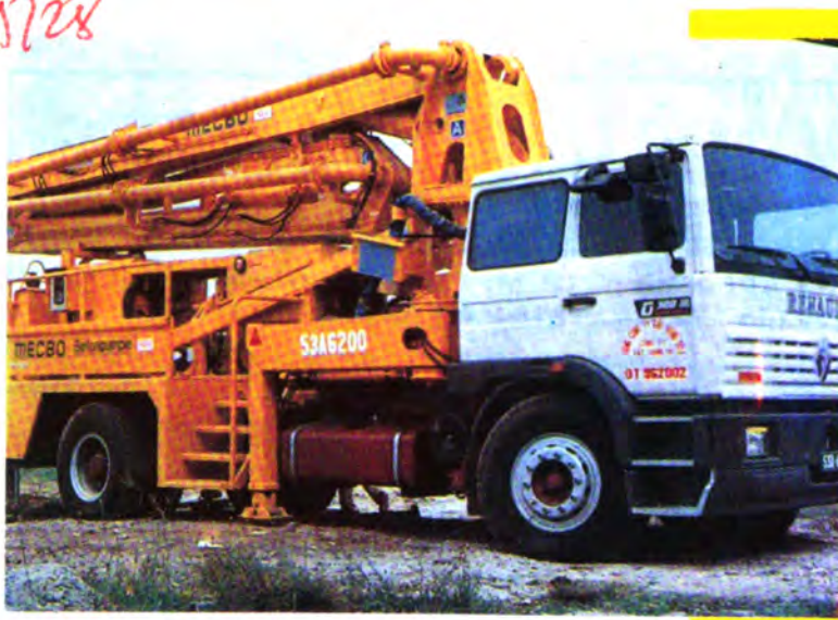
■ Xe bơm bê tông
